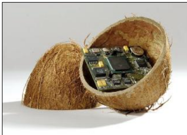
Bild 1. Das FPGA-Modul XV2DDR ist mit einem Virtex-II FPGA bestückt
